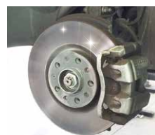
錆び止め塗布後
