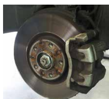
錆び止め塗布前
