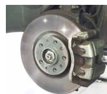
錆び止め塗布後
